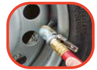
EL CLIP EVITA EL DESACOPPLAMIENTO
