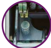
BOTÓN DE SEGURIDAD QUE LIBERA EL MECANISMO
