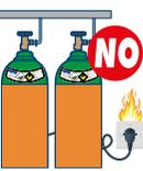
En las áreas para almacenamiento y uso de cilindros, las instalaciones eléctricas deben encontrarse en buen estado y no estar en contacto con los cilindros.
