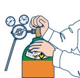
Evite purgar el sistema aflojando las conexiones, no ventear ni abrir la válvula del cilindro sin instalar el regulador. Colóquese a un lado del regulador cuando abra la válvula del cilindro (nunca de frente).
