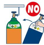
Está prohibida la sustitución de un gas de cualquier tipo por otro. ¡Cuidado! Verifique siempre en la etiqueta, el gas contenido.
