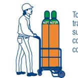
Todos los cilindros deben transportarse en posición vertical, sujetos a un carro porta cilindros y con el capuchón de seguridad bien colocado.
