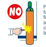
Prohibido exponer los cilindros a fuentes de ignición (chispas, flamas abiertas, fuego, puntos de soldadura, etc.). No calentar los cilindros para tratar de incrementar la presión interna.
