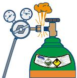
No desconecte los cilindros, hasta verificar que la presión siempre esté en ceros.
